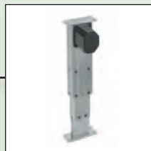
LAMBDA Colonne Hub max: 600 mm Fx max: 4.500 N Vmax: 20 mm/s
