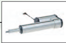
LZ 60 E-Zylinder Hub max: 600 mm Fx max: 4.000 N Vmax: 110 mm/s
